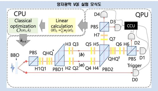
본 실험 장치는 고전 컴퓨터와 양자 시스템이 결합된 하이브리드 구조를 가진다. 좌측의 고전 컴퓨터(CPU)에서는 최적화 연산을 수행하고, 우측의 양자 처리 장치(QPU)에서는 양자 상태의 생성과 측정이 이루어진다.
