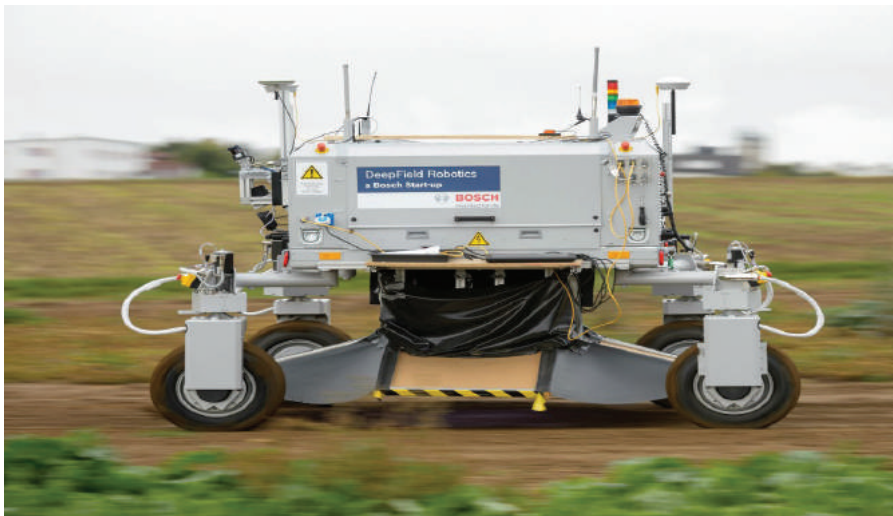
농업선진국에서는 농업 중 노동집약적인 작업 상당수가 자동화됐다. 이에 따라 농업로봇 시장도 급속히 성장할 전망이다. 사진은 독일 보쉬에서 개발한 잡초제거용 로봇 보니로브(Bonirob). © BOSCH
