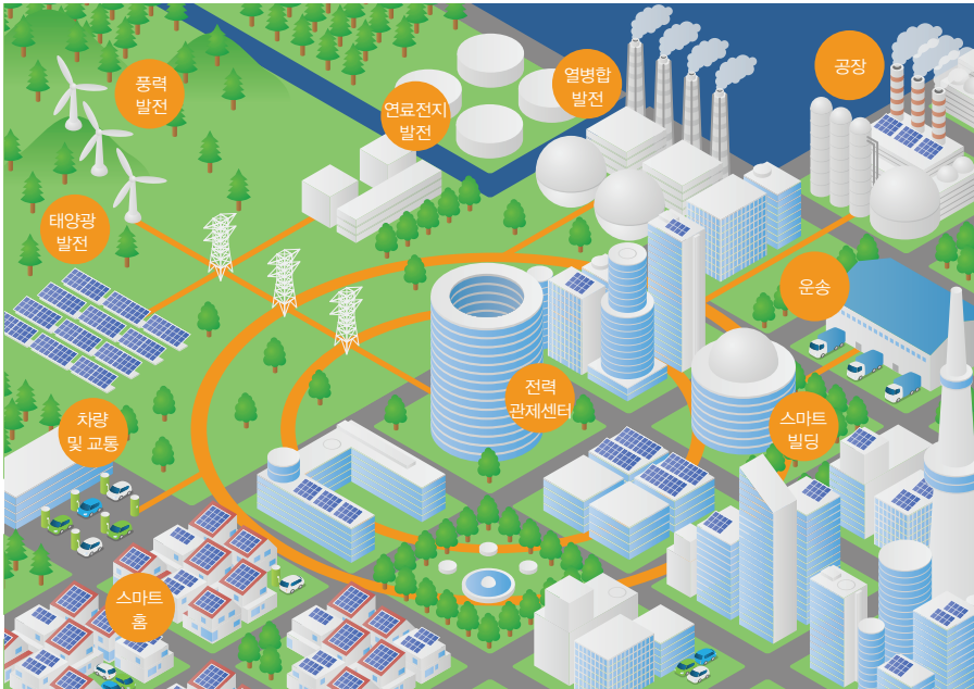
마이크로그리드의 개요. 마이크로그리드는 지역 단위로 사용할 수준의 소규모 전력원 여럿을 다양한 수요처와 연결하고 생산량과 소비량, 전력배분을 실시간으로 제어하는 것이다. 이를 이용하면 송전 손실을 줄이고 과도한 전력과 에너지 소비를 방지함으로써 지속가능한 에너지 시스템을 구축할 수 있다.
