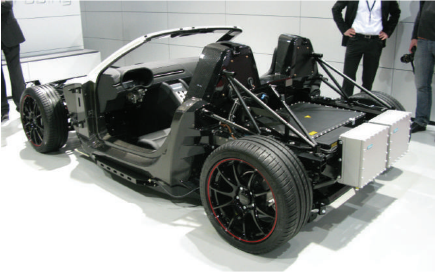
아직 강도 면에서 개선이 필요하지만, 지금도 탄소섬유강화 플라스틱은 금속을 대신하여 사용되고 있다. 사진은 2013년 제네바 모터쇼에 출품된 독일 자동차회사 로딩(Roding)사의 로드스터. 차체를 탄소섬유 플라스틱으로 제작했다. © MOTORTREND
