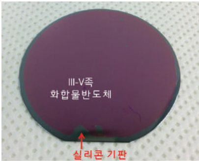
접합법으로 III-V족 화합물반도체를 실리콘 위에 형성한 기판. 청록색 부분이 실리콘 기판, 보라색 부분이 형성된 III-V족 화합물반도체다. 최근 KIST에서 개발한 것이다.
