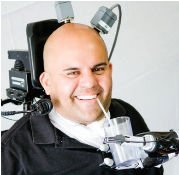
뇌-기계 인터페이스는 이미 생각을 읽는 수준에 이르렀다. 캘리포니아 공과대학의 연구팀은 사람의 머리에 칩을 심어서 생각만으로 로봇 팔을 제어하는 데 성공했다. © Caltech
