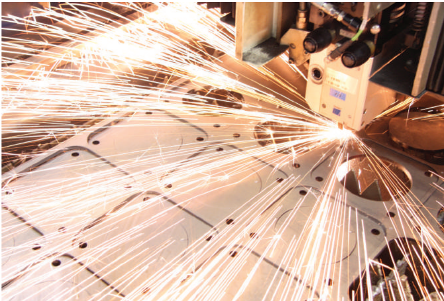
금속을 정교하게 절단할 수 있는 레이저 가공은 현대의 금속 가공에서 빼놓을 수 없는 공정이다. 절단용 레이저에 광섬유 레이저 활용이 늘어나면서, 물질 분석부터 모니터링에 이르기까지 적용분야도 다양해지고 있다. © RAUCH SPEKTRUM s.r.o.
