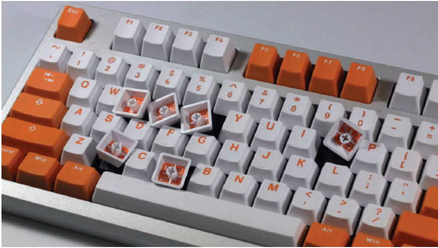
PBT는 물성이 우수하고 저렴해서 다양한 소비재에 널리 사용된다. 특히 반복적인 충격을 견뎌야 하는 키보드와 같은 부품에 최적의 소재로 손꼽힌다. © MechanicalKeyboards.com
