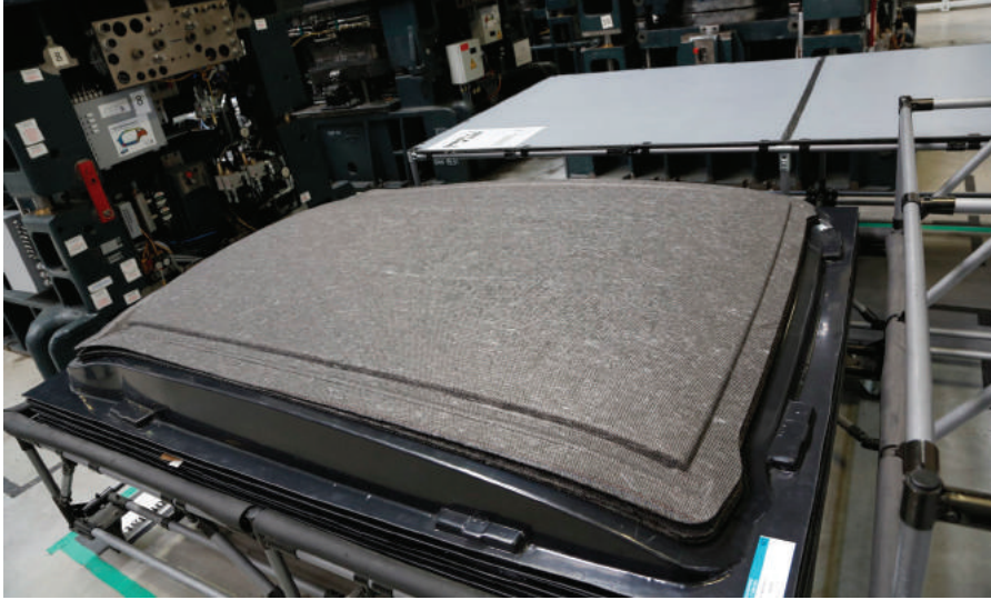
버려지는 탄소섬유는 잘게 잘려서 다양한 구조물의 보강재로 사용된다. 독일의 자동차회사, BMW에서 생산하는 i시리즈의 좌석에도 이렇게 재활용된 탄소섬유가 활용된다. 최근에는 탄소섬유 폐기물을 다시 섬유 형태로 재생하려는 연구도 한창이다. © BMW
