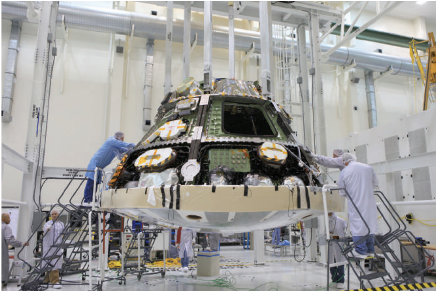
엔지니어링 플라스틱 중 일부는 금속보다도 내마모성과 내열성이 우수해서 우주공간의 극한 환경과 대기권 돌입 시의 고온에서도 신뢰성을 유지할 수 있어 우주선 제작에 활용된다. 사진은 NASA의 차기 우주선인 오리온의 시험용 모델을 제작하는 모습. © NASA
