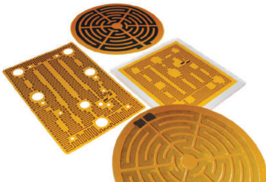
폴리이미드는 온도변화에 강하면서도 유연성과 전기절연성이 좋아 회로 기판에 이용된다. 사진은 폴리이미드를 이용한 프린트 기판. © dbk group
