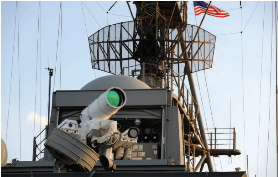
미국의 상륙함 'USS 폰스'에 시험 배치된 레이저 무기인 LaWS. 아직 충분한 성능은 아니지만 로켓 요격시험에 성공하는 성과를 올렸다. © US Navy
