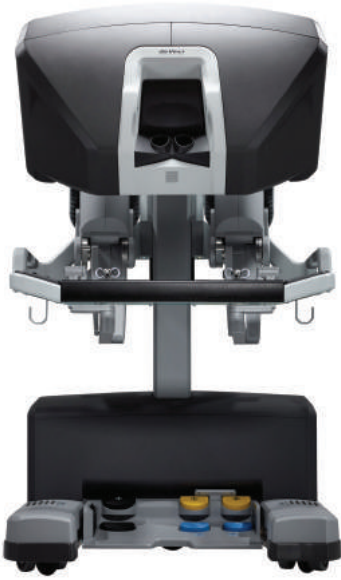
로봇 수술 시스템인 '다빈치'의 의사용 콘솔(왼쪽)과 수술장면(오른쪽 위) 및 조작부(오른쪽 아래). 콘솔의 디스플레이에 3D 기술이 적용되면 수술대상과 로봇팔의 위치를 정확하게 측정할 수 있어 이전보다 정교하고 안전하게 수술할 수 있다. © Da Vinci
