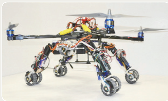
▲ 그림 6. 지상 로봇과 드론 헬기가 결합한 통합형 로봇
