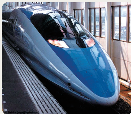
▲ 그림7. (좌) 물총새 부리를 모방하여 만든 신칸센 앞부분, (우) 물총새
