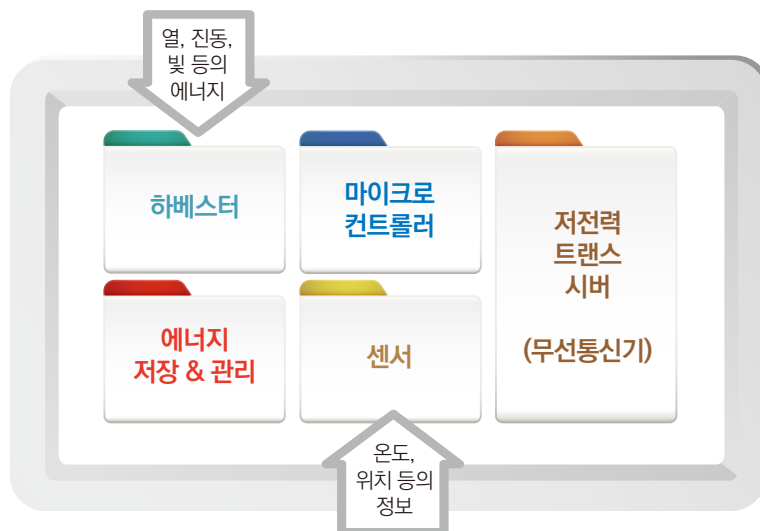
▲ 그림9. 센서가 포함된 에너지 하베스팅 시스템 개념도
