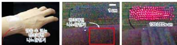
▲ 그림8. 접촉대전 나노발전기의 특성을 이용해 '웨어러블 전원 공급 장치'로 응용한 모습
