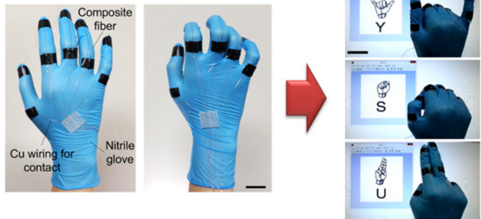
그림 4. 변형 센서 하이브리드형 고신축성·전도성 섬유를 이용하여 제작한 스마트 장갑 및 수화 동작 인식
