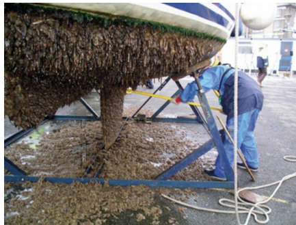
🔍 그림 7. 해양 생물 증식에 의한 선박 및 파이프의 파울링 현상
