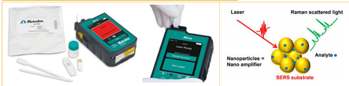
그림 8. 미국 Metrohm Raman社の SERS 기반 마약 검출 키트 및 SERS 원리
