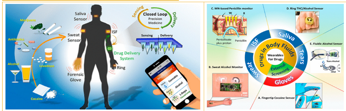
그림 20. 웨어러블 전기화학 센서를 이용한 약물검출 기술들
