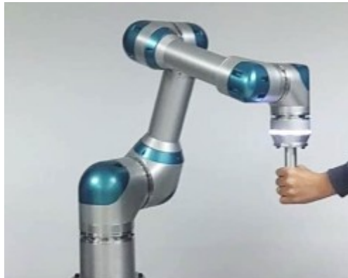
그림 1. 모듈화 및 경량화 설계에 기반한 협동로봇
