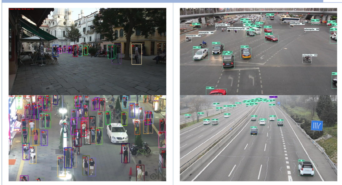
그림 8. CNN 기반 객체 탐지 알고리즘을 이용한 보행자 탐지 결과 및 차량 탐지 결과
