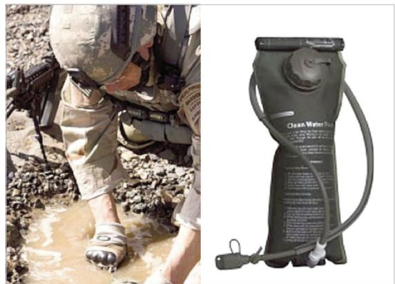
그림18. HTI사의 팩 형태 휴대용 정삼투 정수장치, 오염된 물을 한쪽에 채우면 정삼투막을 통과하여 시럽이 들어있는 반대쪽으로 순수한 물만 이동하여 결과적으로는 안전한 음료를 얻게 된다.
