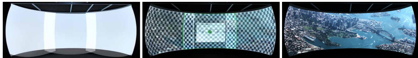
그림10. (좌)Projection 영역, (중)Geometry 정보 분석, (우)보정 후
