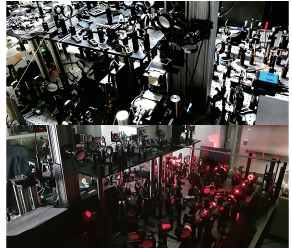
본 연구진이 개발한 초고속 홀로그래프 현미경. 기존보다 영상 획득 속도를 수십 배 높여 살아있는 생물의 신경망까지도 관찰 가능하다.
