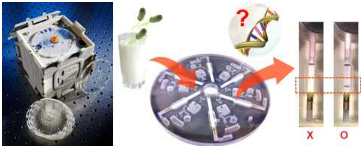
<그림> 원심력을 이용한 Lab-on-a-disk 칩
