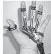
공압식 인공근육을 사용하는 유사한 재활기기로 미국 키네틱 머슬사의 손목 및 발목용 “멘토(Mentor)”가 있다(그림 2-17 b). 손목용 멘토는 1개의 공압식 인공근육을 사용하여 손목을 당기는 역할을 한다. 손가락의 독립적인 재활훈련은 불가능하지만, 이중 링크 메커니즘을 사용하여 손목과 손가락의 신전 훈련이 동시에 가능하다. 유사한 기능을 발과 발목의 반복적인 운동에 적용한 발목용 발 멘토도 개발하였다. 미국 럿거스 대학은 뇌졸중 환자의 엄지와 검지, 중지, 약지의 신전과 쥐는 동작의 훈련이 가능한 “럿거스 마스터 II (Rutgers master II)”를 개발하였다(그림 2-17 c). 이는 공
