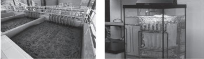
정삼투 막여과 기술은 삼투압을 원동력으로 사용하는 막여과 공정으로 삼투압을 최대로 유발할 수 있는 전용막 개발이 무엇보다 중요하다. 정삼투 분리막은 삼투 방향으로의 높은 물 투과성을 가져야 하고 역방향으로 유도용액의 용질이 확산되지 않게 설계하는 것이 중요하다. 이를 위해 정삼투 전용 분리막은 두께가 얇고, 친수성을 띠어야 하며, 막의 구조는 물의 이동 거리를 최소화 할 수 있어야 한다. 이러한 특성과 함께 막오염 제어가 가능하여야 하므로, 정삼투 막여과 기술은 고도의 전문성을 요하는 기술영역에 해당된다.
