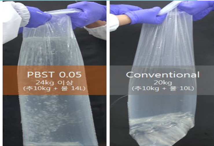
그림 25. PBST, Conventional Blown 필름의 종량제봉투 활용 적합성 테스트
