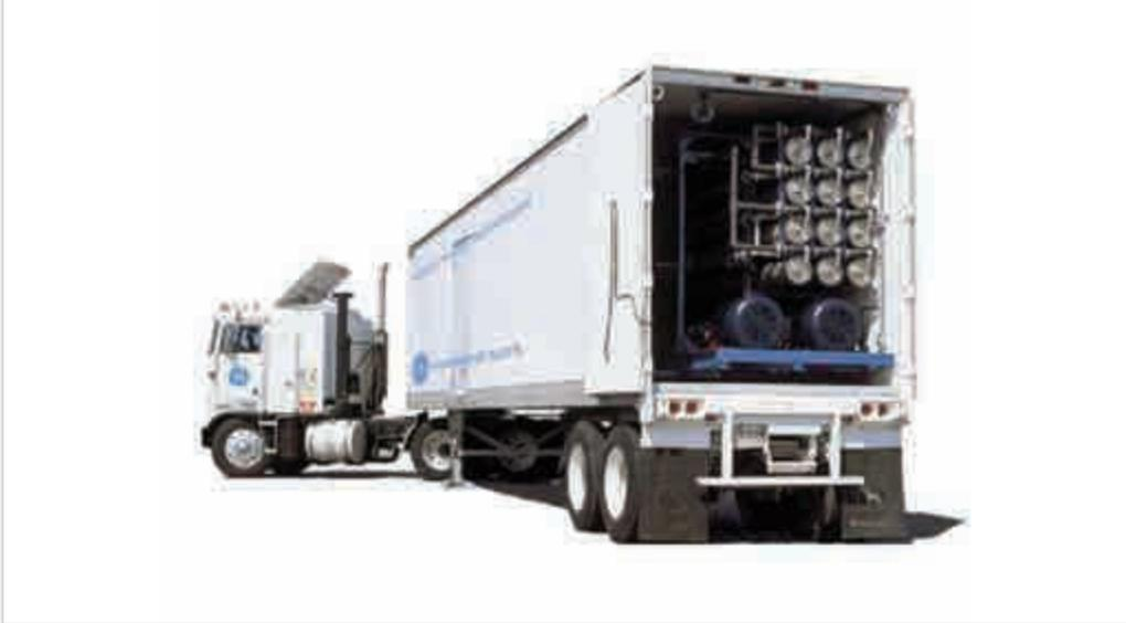
그림 12. 이동식 수처리 시스템(Mobile Water Treatment System)(출처: GE)
