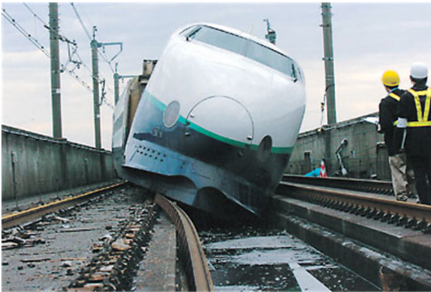
그림 2. 2004년 10월 23일 규모 6.6 일본 니이가타 지진으로 인한 고속열차 신간선의 탈선 ( http://web-japan.org/nipponia/nipponia33/en/feature/feature10.html )
