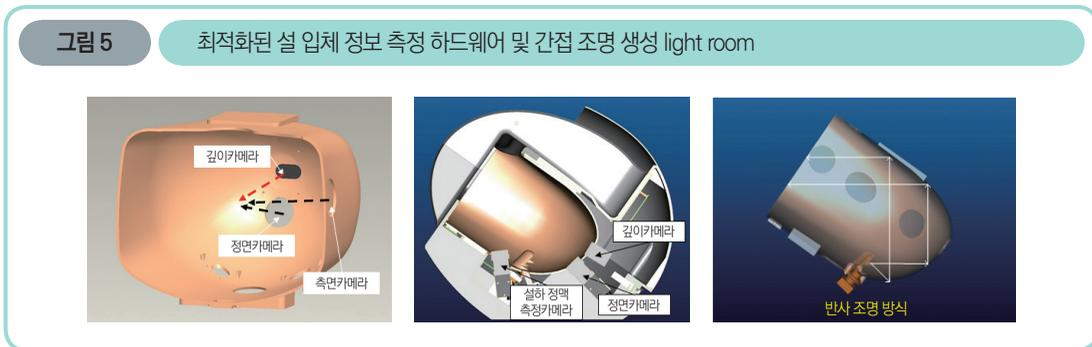
그림자 영향 및 침에 의한 영상의 왜곡을 최소화 할 수 있는 조명 환경을 설계하였다. 반사판 형태의 light room을 구성하여 균일한 강도의 빛이 조사되는 간접조명 환경에서 영상 획득이 가능하도록 하였고, 허에 다양한 각도에서 반사된 조명이 입사하도록 하여 설 표면 굴곡에 의한 그림자가 발생하지 않도록 하였다. 특히, light room 내부에서 다양한 각도로 반사되어 생성되는 조명 환경을 조성하여 직접광 환경에서 발생하는 침 반사 문제를 최소화 하였다[53].
