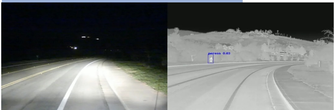
그림 31. 야간 자율주행 영상에서의 RGB + IR 보행자 인식 예
