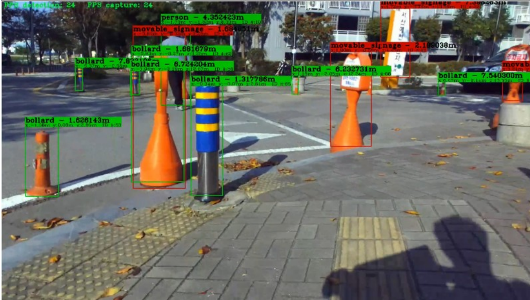
그림 32. 도로 영상에서의 로봇 운영 체제와 Stereo 카메라(RGB·Stereo) 객체 인식 예
