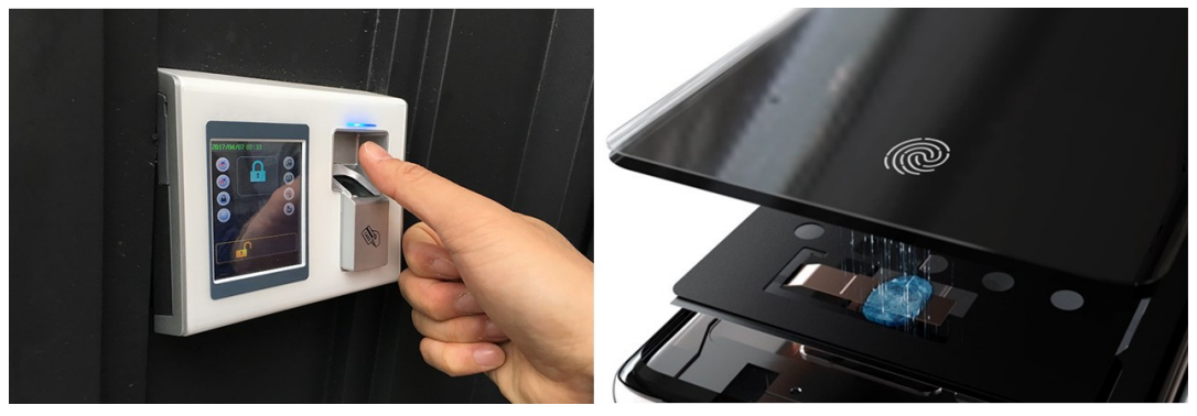
그림 4. (좌) 벌크형 센서, (우) 필름형 센서
