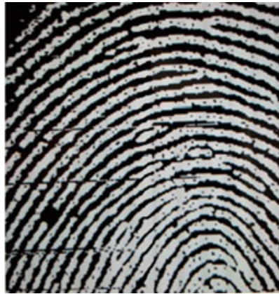
그림 11. ETRI-UNIST-크루셜텍 공동개발 정전용량방식 지문인식 센서기술로 얻은 지문 이미지
