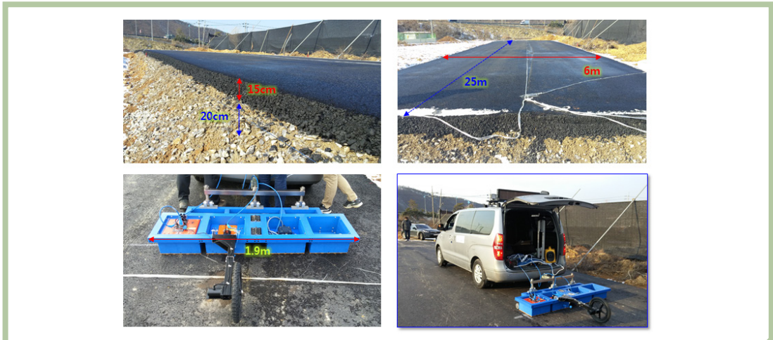
그림 23. 도심지 모형지반 GPR 탐사
