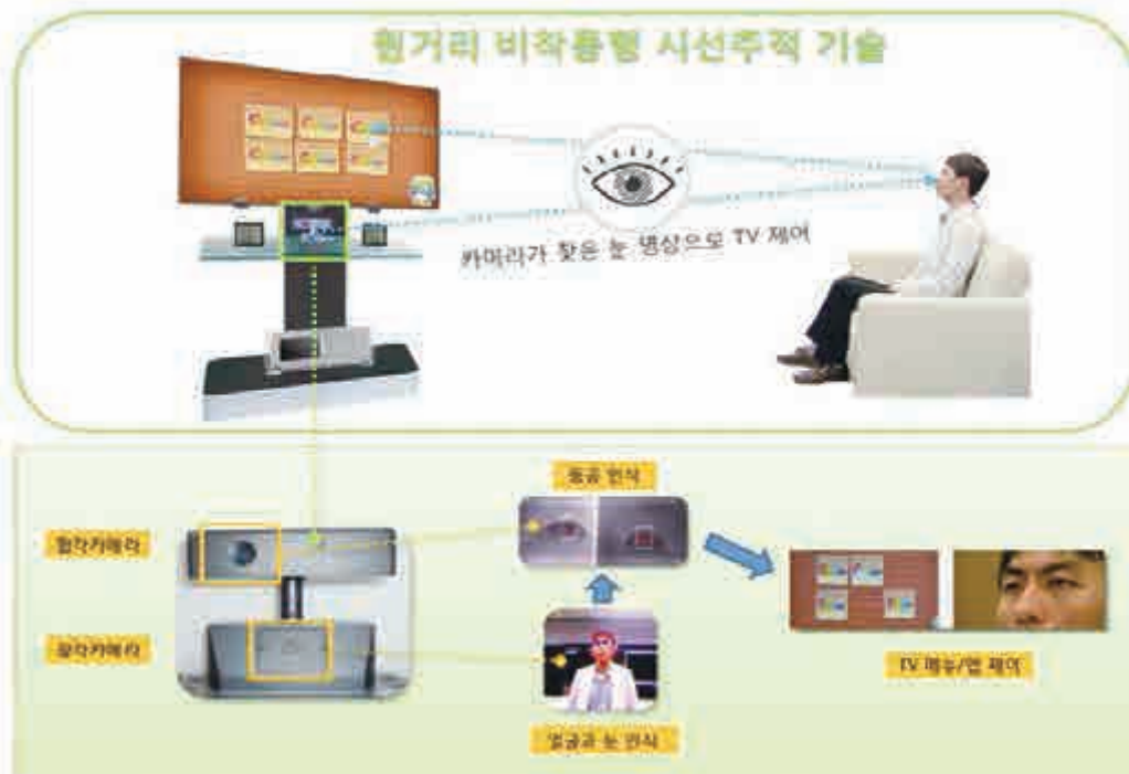
그림 11. 원거리 비착용형 시선추적기술 원리
