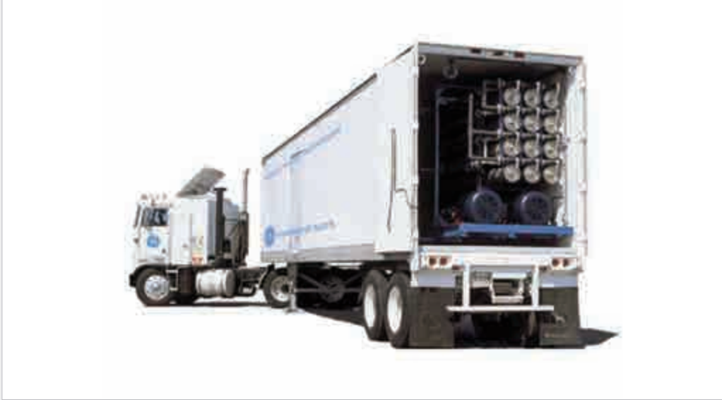
그림 12. 이동식 수처리 시스템(Mobile Water Treatment System)(출처: GE)
