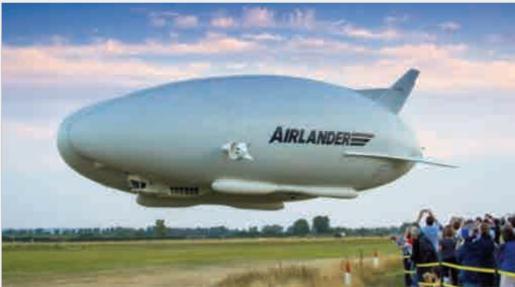
그림 13. 세계에서 가장 큰 비행체-유효하중 도량 10톤(하이브리드 비행체) World Biggest Aircraft - Payload Capacity up to 10 ton (Hybrid Air Vehicles)
