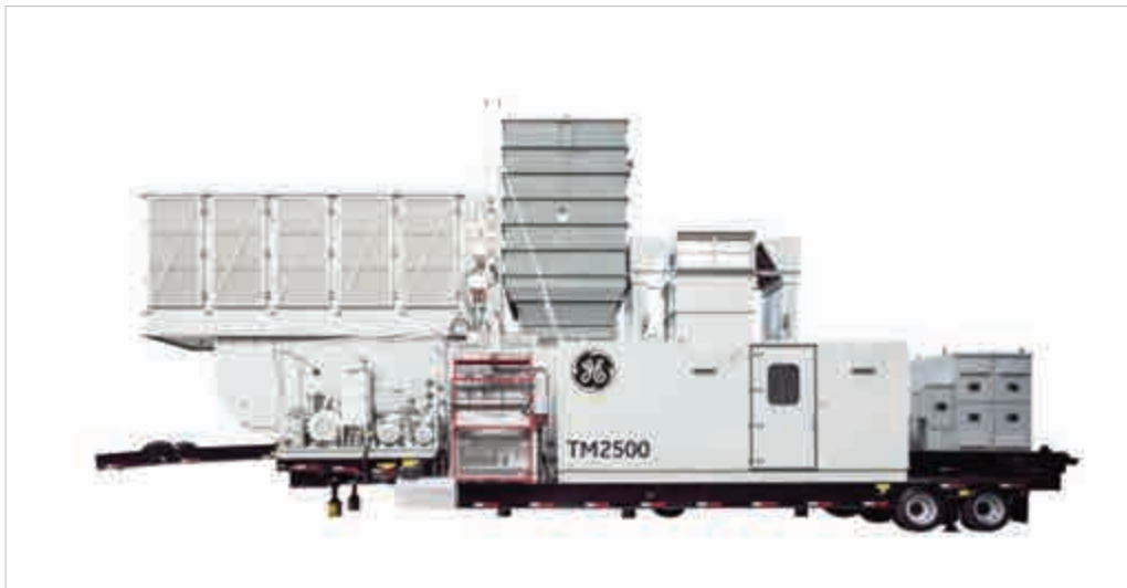
그림 11. 이동식 대용량 발전기(Mobile Power Plant)(출처: GE)
