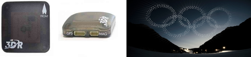
그림 9. (좌) 상용 GNSS 센서 모듈, (우) RTK GNSS를 이용한 군집 드론 비행
