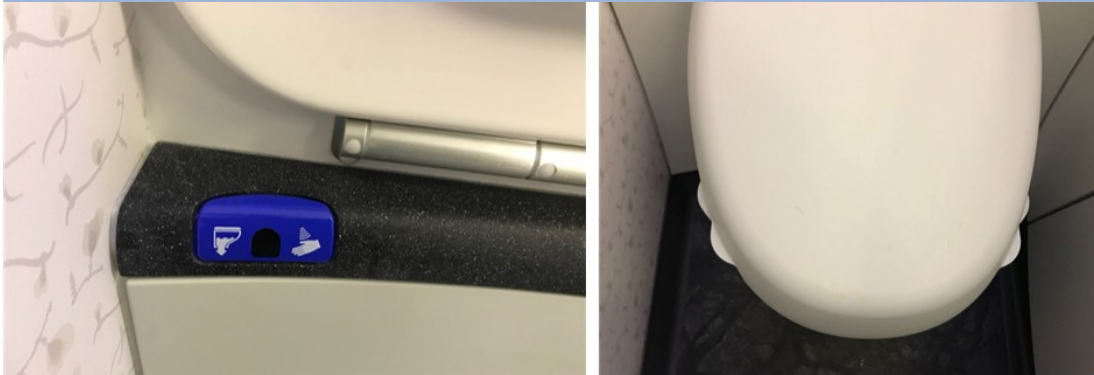
그림 12. 보잉 777 캐빈 화장실의 무선 플래쉬 센서(왼쪽)와 위생을 강조한 변기 덮개 디자인(오른쪽)
