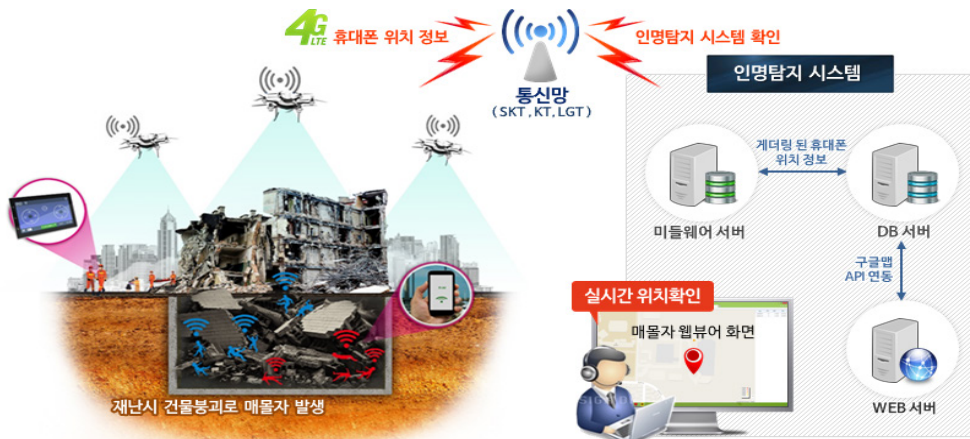
그림 3 무인비행체(드론)기반 인명탐지 체계 구성도
