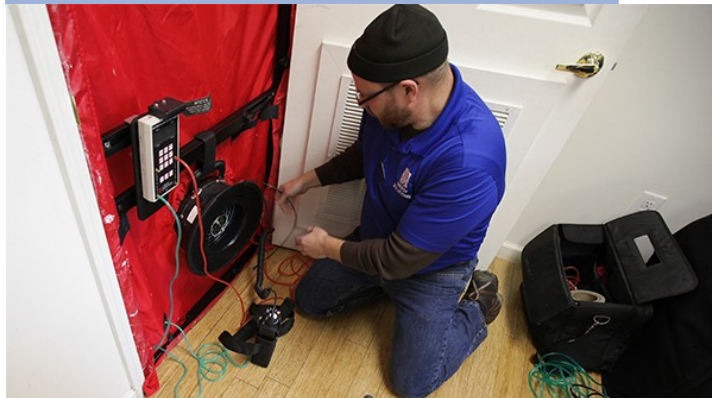
그림 11. 팬 가압법을 이용한 측정 방법
