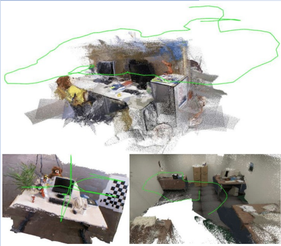
그림 11. RGB-D 카메라 기반 SLAM을 통한 3차원 공간 복원
