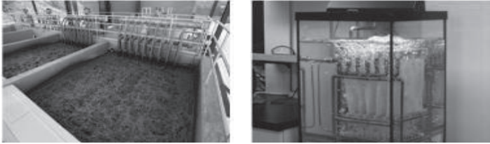
| <그림 2-109> 분리막 생물반응조 운전(좌)과 막오염을 막기 위해 반응조 내에서 폭기하는 모습(우) |
