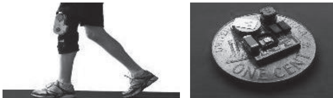
| <그림2-29> 미국 바이오닉 파워사에서 개발한 인체 부착형 에너지 획득 시스템(좌)와 미국 미시간 대학에서 개발한 Piezoelectric 방식을 이용하는 에너지 획득 시스템(우) |
