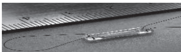
| <그림 2-24> CardioMEMS사에서 개발한 혈관삽입형 혈압 측정 시스템 |
