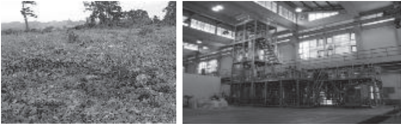
| <그림 2-105> 인도네시아에 설치중인 바이오에탄올 파일럿플랜트와 원료인 팜유의 부산물(EFB, Empty Fruit Bunch) |
